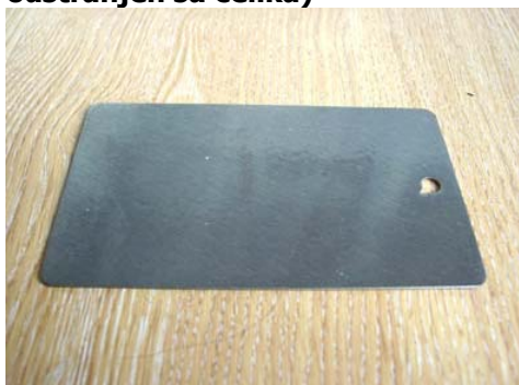
Sl. 2. Stanje oglednog trajnog premaza na kraju ispitivanja
