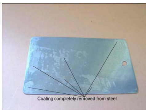
Sl. 1. Stanje oglednog polu-trajnog premaza na kraju ispitivanja (premaz je potpuno odstranjen sa čelika)
